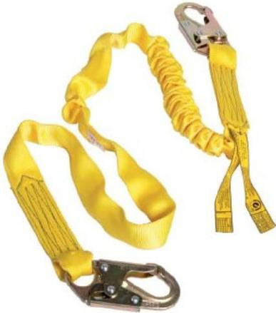
**Ref. AC07:** Eslinga tubular marca Arseg, con mosquetón en acero de doble seguro en cada uno de sus extremos de 3/4" de apertura. Longitud de 1,8 m de largo. Sistema de absorción de energía conformado por materiales textiles que en caso de caída reduce la fuerza del impacto a 410 Kgf o menos.
