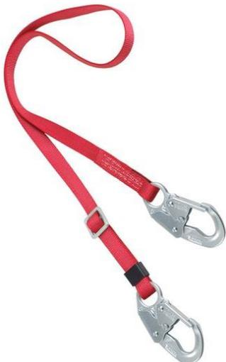
**Ref. AC05:** Eslinga de posicionamiento regulable, marca Arseg, soporta hasta 900 lb. No incluye dispositivo absorbedor de shock. Una sola longitud ajustable, con ganchos de seguridad en cada extremo x 1,8m (6 ft).
