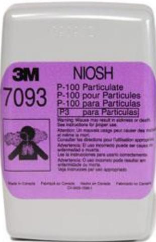
**Ref. RE21:** Filtro 7093 de 3M, está diseñado para acoplarse a las máscaras 3M de series 6200, 6502, 6800 y 7502. Brinda protección respiratoria principalmente contra partículas, su material filtrante está recubierto con aditivos repelentes a líquidos, y su cubierta es resistente a altas temperaturas. Cumple norma NIOSH P100. Uso en humos metálicos de soldadura, cadmio, arsénico, asbesto, minería.
