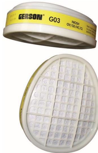
**Ref. RE27:** Cartucho G03 de GERSON, está diseñado para acoplarse a las máscaras media cara y cara completa de GERSON. Brinda una protección respiratoria contra vapores orgánicos y gases ácidos. Sus usos se encuentran en fundiciones mineras, plantas de concentrado minero, industria petroquímica. Cumple con la aprobación NIOSH.
