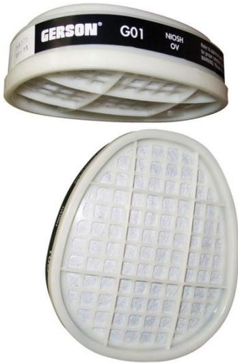
**Ref. RE26:** Cartucho G01 de GERSON, está diseñado para acoplarse a las máscaras media cara y cara completa de GERSON. Brinda una protección respiratoria contra vapores orgánicos. Sus usos en exposiciones a vapores orgánicos de acuerdo a las especificaciones OSHA, pesticidas, insecticidas, pinturas, industria petroquímica. Cumple con la aprobación NIOSH.
