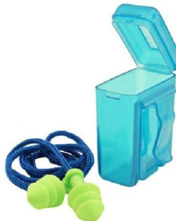
**Ref. AU12:** El tapón reutilizable brinda un nivel de atenuación de ruidos (NRR) de 26 dB. Modelos 900473 y 901467 (con caja plástica). Son fabricados con caucho sintético hipoalergénico para fácil limpieza y lavado, tienen un diseño de triple falange que permite mejor ajuste en el canal auditivo, y un vástago ergonómico que facilita la inserción en el oído. Cumplen con la norma ANSI S3-19-1974.
