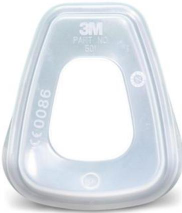
**Ref. RE19:** El retenedor de 501 3M, es utilizado para fijar 5N11 de 3M a los filtros 3M de la serie 6000. En conjunto con el filtro 5N11 y los filtros de la serie 6000 brindan una efectiva e higiénica protección respiratoria contra polvos y partículas líquidas sin aceite, gases y vapores. Aplicaciones en tinturado, minería, construcción, pintura en spray, empackado, cemento, aserrado.
