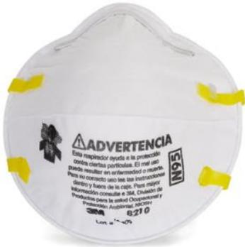
**Ref. RE01:** Brinda una efectiva, confortable e higiénica protección respiratoria contra partículas sólidas y líquidas sin aceite. Fabricada con medios filtrantes electrostáticos para mejor filtrados y evitar la caída de presión. Cumplen con la norma NIOSH N95, 42CFR84. Uso en minera, construcción, manejo de agroquímicos, madera, alimenticia, sanitaria.
