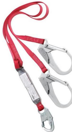
**Ref. AC04:** Eslinga absorbidora de Shock de doble terminal con mosquetón de 2 ¼" de apertura en los extremos de las terminales y de 1,8m (6 ft) de largo, diseñada para limitar el promedio de la fuerza de detección de caída a 900 lb para mayor seguridad.
