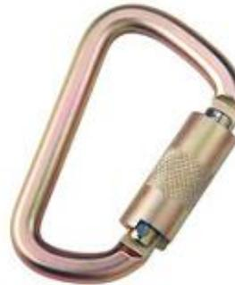
**Ref. AC10:** Mosquetón marca Saflok, elaborado en acero con abertura de compuerta de 17,5 mm compuerta de cierre y bloque automático. Soporta una carga de 22 KN (5000 lb). L mecanismo de doble acción se cierra y se bloquea de manera automática para mantener fijos todos los componentes del sistema de seguridad.
