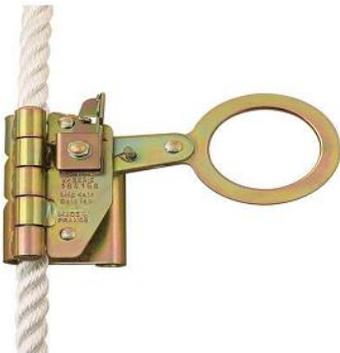
**Ref. AC11:** Sujetador móvil y manual para cuerda modelo AC20 marca Protecta, cuenta con un diseño para manos libres que permite seguir al usuario automáticamente al subir o bajar para obtener mayor libertad de movilidad. Un sistema de freno sencillo pero muy eficaz que utiliza una palanca de leva para detener la caída del usuario.
