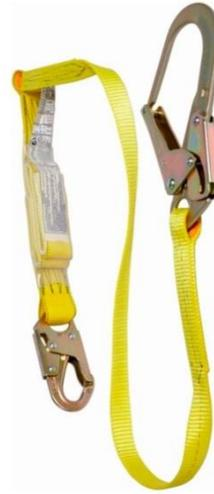
**Ref. AC08:** Eslinga con mosquetón de 3/4" de apertura., acero de doble seguro en el extremo más próximo al sistema de absorción de energía. Termina en un mosquetón de 2 1/4" de apertura, con doble seguro de auto bloqueo, estos ganchos poseen una resistencia en el cuerpo de 5000 lb. Fabricada en reata de poliéster de 1". Soporta hasta 816 Kgf.
