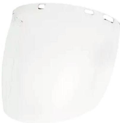
**Ref. VI07:** Protector facial de alto impacto. Pantalla fabricada en policarbonato para proteger la cara de golpes, impactos de partículas, polvo, chispas y salpicaduras químicas. Diseño envolvente. Filtro UV. Dimensiones 8x15½". Espesor 2 mm para alto impacto. Marca Libus.
