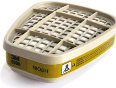
**Ref. RE14:** Cartucho 6006 de 3M, está diseñado acoplarse a las máscaras 6200, 6502, 7502, 6800. Brinda protección respiratoria contra ciertos vapores orgánicos, cloro, dióxido de azufre, cloruro de hidrógeno. Sus usos se encuentran en soldadura, pintado, industria del acero, agroquímicos, minería, petroquímica, alimenticia, farmacéutica.
