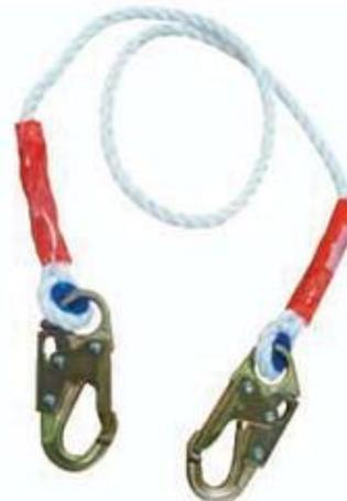
**Ref. AC06:** Eslinga para posicionamiento fabricada en cuerda trenzada de ½", cuenta con gancho de seguridad, mosquetón de doble seguro en cada uno de sus extremos con apertura de ¾", resistencia de 5000 lb en el cuerpo y 3600 lb en el gatillo. Longitud 1,8 m. soporta 100 Kg de peso de caída, sin liberación del peso prueba, muy resistente. Cumple la norma ANSI 10.32-2004.
