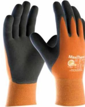
**Ref. MA26:** Guante de látex natural sobre un forro acrílico o de poliéster sin costuras con agarre contra deslizamientos patentado, diseñado para la manipulación general en medios húmedos o secos a temperaturas bajas. Marca ATG, modelo 30-201. Cumple las normas BS EN407:2003, EN511:2003 y BS EN388:2003. Tallas 7-8-9.
