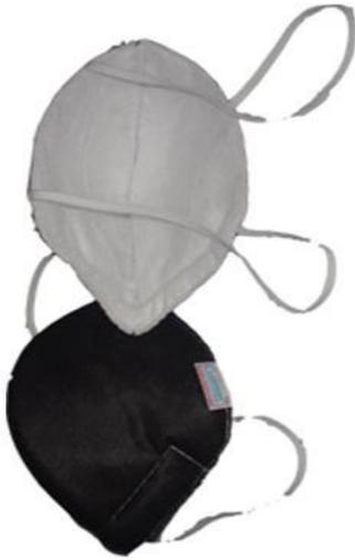
**Ref. RE07:** Brinda una efectiva, confortable e higiénica protección respiratoria contra polvo y partículas no tóxicas. Son fabricados en cinco capas antialérgicas de medios filtrantes electrostáticos para mejor filtrados y evitar la caída de presión. Aplicaciones minera, maderera, construcción, metal metálica, manejo de agroquímicos, florícolas. Cumple norma NTE INEN 2348.
