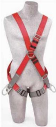
**Ref. AC03:** Arnés de 4 anillos cruzado, marca DBI SALA, reatas de poliéster, seguro de red de polietileno, peso físico 3,4 lb, arnés tipo paracaidista modelo cruzado con 4 anillos tipo "D", 1 en el pecho, 1 en la espalda y 2 en la cintura, con hebillas tipo pasante. Cumple con la norma OSHA 1,910.66, ANSI A10.32.
