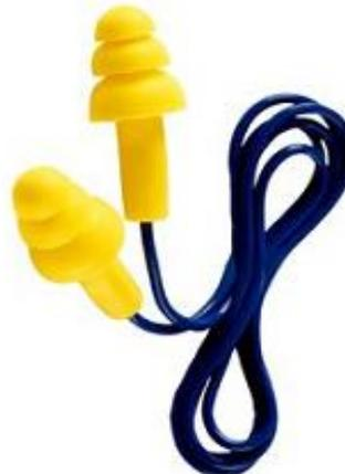
**Ref. AU06:** El tapón ultrafit brinda un nivel de atenuación de ruidos (NRR) de 25 dB. Son fabricados con caucho sintético hipoalergénico para fácil limpieza y lavado, tienen un diseño de triple falange que permite mejor ajuste en el canal auditivo, y un vástago ergonómico que facilita la inserción en el oído. Cumplen con la norma ANSI S3-19-1974.
