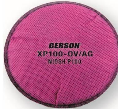
**Ref. RE33:** Filtro XP100 VO/GA, brinda protección respiratoria contra vapores orgánicos y gases ácidos. Cuenta con capas de carbón activado para remover niveles molestos de vapores orgánicos. Cumple con la norma NIOSH P100. Usos sugeridos: soldadura eléctrica, soldadura MIG/TIG, procesos químicos, revestimiento asfáltico, ozono.
